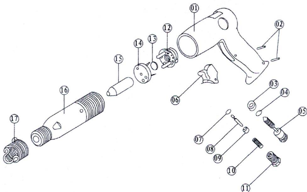
1. Корпус - рукоятка 2. Палец 3. Седло клапана 4. Кольцо резиновое 5. Регулятор подачи воздуха 6. Кнопка пусковая 7. Кольцо резиновое 8. Палец 9. Направляющая пальца 10. Пружина 11. Штуцер воздушный входной 12. Корпус клапана задний 13. Диск клапана 14. Корпус клапана передний 15. Поршень ударный 16. Цилиндр 17. Держатель быстросъемный.
